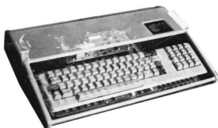
Afb. 1. In één behuizing zijn de microcomputer en het toetsenbord aangebracht.
